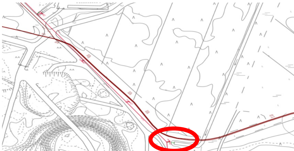
Bild 2: Anslutningspunkt för avrinning från skogen till avfallsvattenreningsverkets utloppsrör
