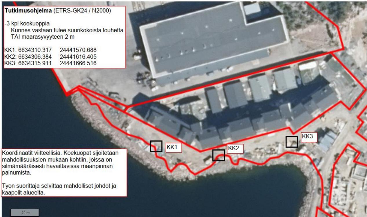
Kuva 4. Ote tutkimusohjelmasta. Koekuoppaa 2 syvennettiin noin kolmeen metriin.
