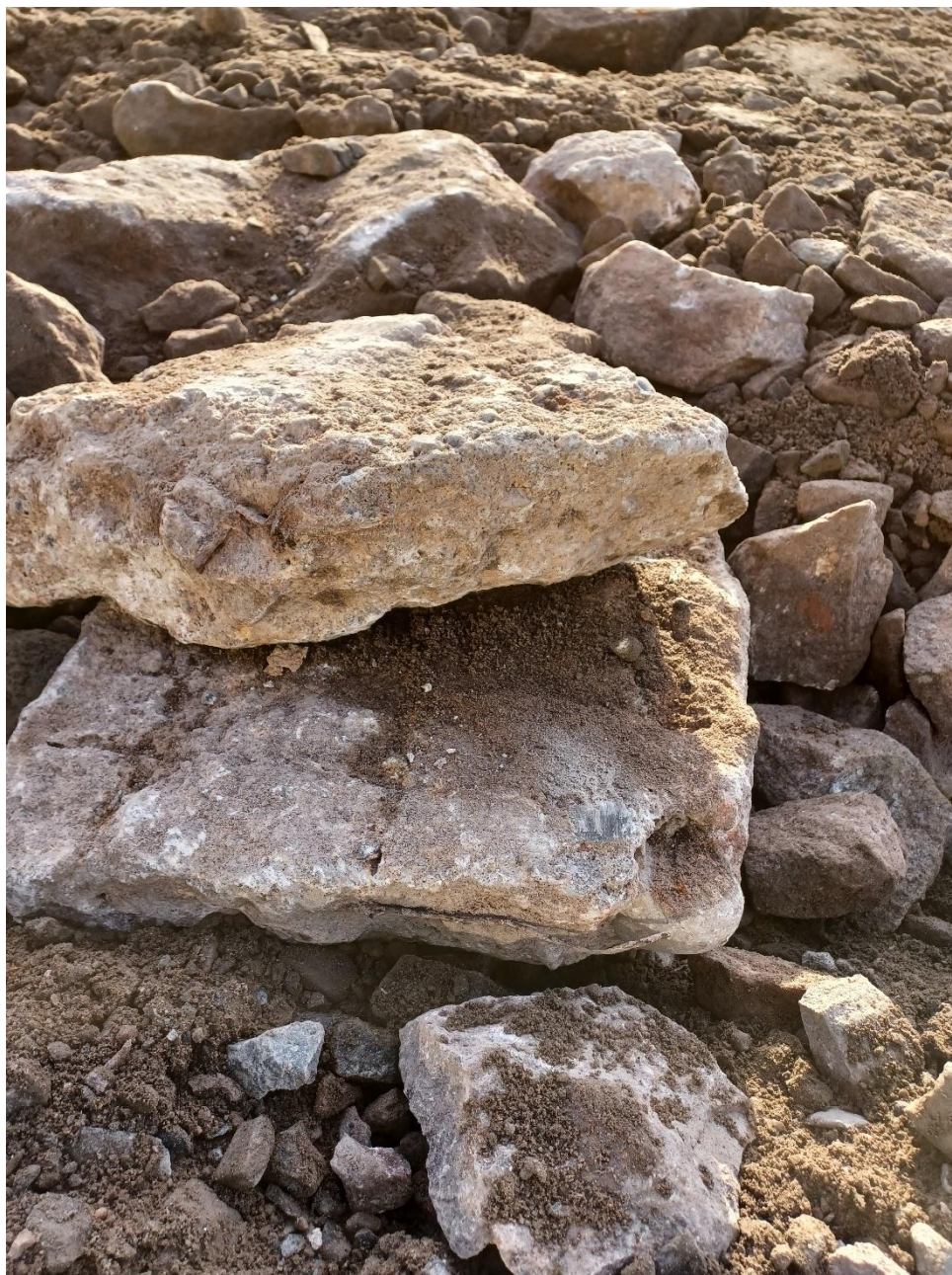
Kuva 9. Betonijätettä louheen seassa koekuopasta 3.
