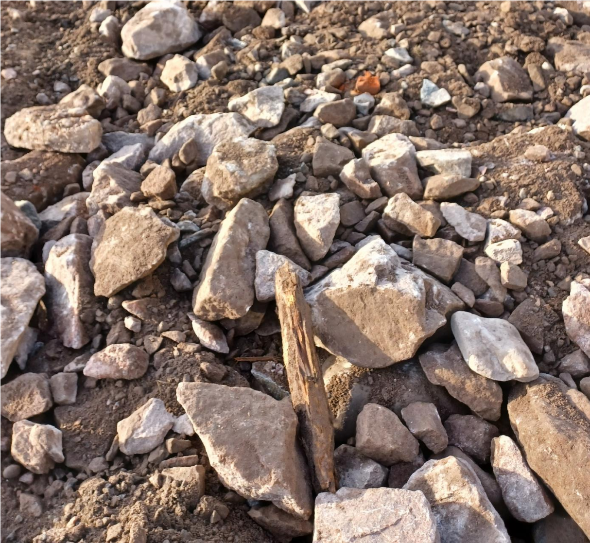
Kuva 8. Koekuoppa 1 kohdalta kaivettua louhetta, jossa on betoni-, tiili- ja puujätettä seassa.
