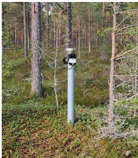
Kuva 1/Bild 1. Jatkuvatoininen pinnanmittaus havaintoputkessa/Kontinuerlig ytmätning i observationsröret
